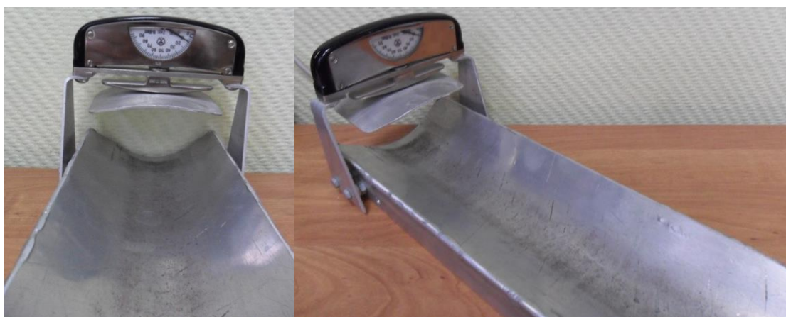
Рисунок 4 – Предложенное устройство для измерения силы мышц предплечья
